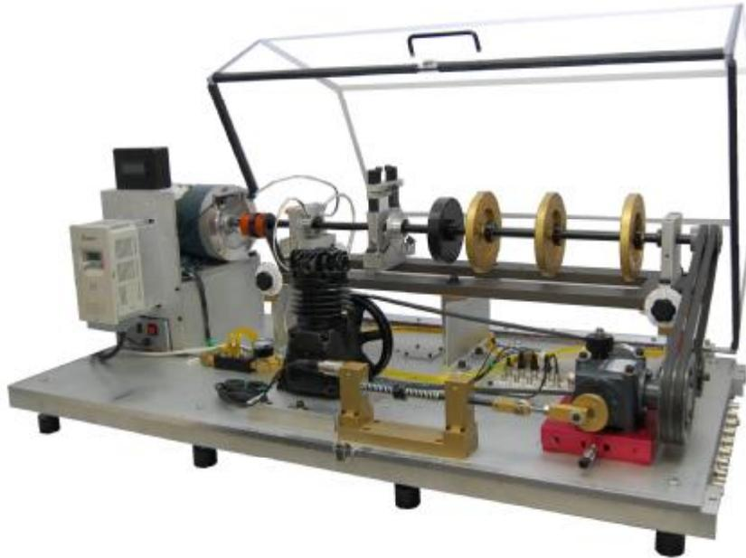
机械故障轻则影响产品质量，重则导致停产，影响整个生产过程。基于状态监测的预知维护在故障发生前发现故障并采取相应措施，是保障设备正常运行、避免经济损失的有效手段。预知维护技术主要依赖于准确、有效的振动信号采集，并对其进行分析，提取振动特征，构建与设备状态的映射关系。公司生产的“机械故障综合模拟实验台-完整版”是一个创新性实验台，可模拟机械设备常见故障，用于故障诊断研究，不会影响您的生产进度和效益。模块化组件设计的实验台功能强大、操作简
