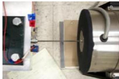
图 5-10 力传感器测量激振器的输入激振力
